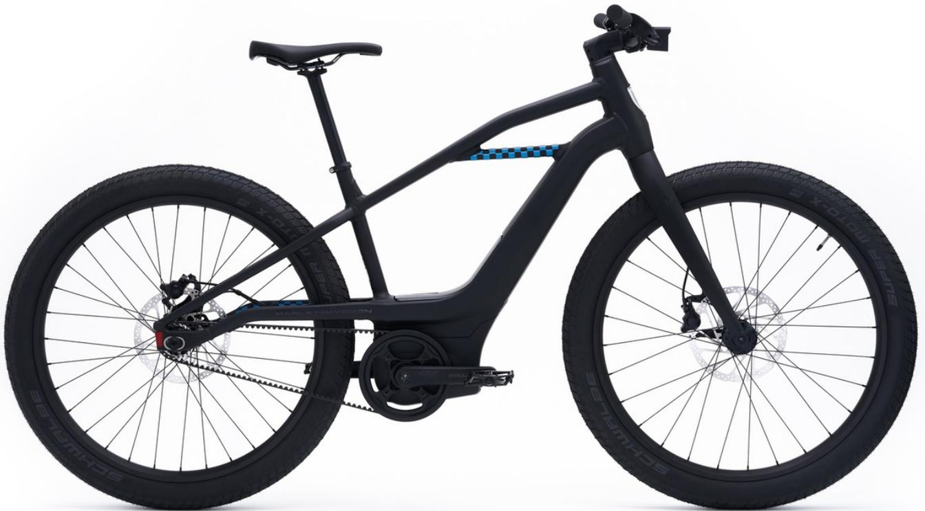
**Rahmen: Hydrogeformter Aluminium Rahmen, geschweißte Konstruktion, innenverlegte Züge**
